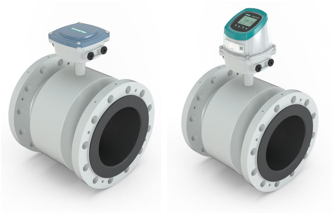
Le boîtier du capteur et les brides sont réalisés en acier inoxydable (AISI 304) ou en acier au carbone (ASTM A 105) et la boîte de raccordement en polycarbonate. Le tube de mesure est en acier inoxydable (AISI 304) alors que les revêtements et électrodes sont disponibles dans divers matériaux, ce qui rend le capteur très résistant à de nombreux produits chimiques.
